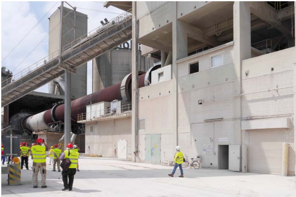
Abb. 5 Im 80 m langen Drehrohrofen wird bei einer Temperatur von 1050 °C der Rohstoff in
