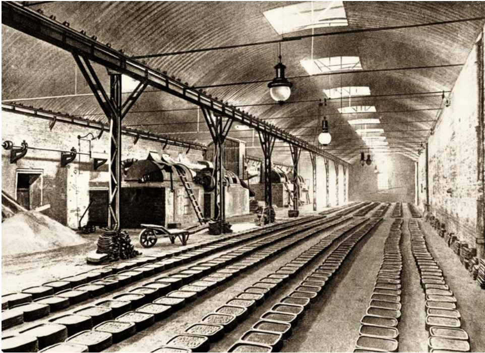
Abb. 21 Blick in eine Produktionshalle für Asphaltmastixbrote. Die Asphaltmischung wurde mehrere Stunden lang gekocht und dann in eiserne Formen gegossen. Nach dem Abkühlen
